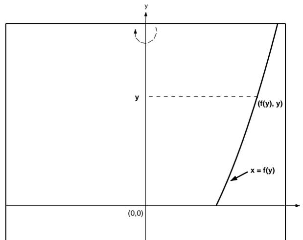
Figure 2: Die Profilkurve der Wasseruhr ist durch die Gleichung  $x = f(y)$  gegeben. Das Gefäss entsteht durch Rotation der Profilkurve um die  $y$ -Achse.
